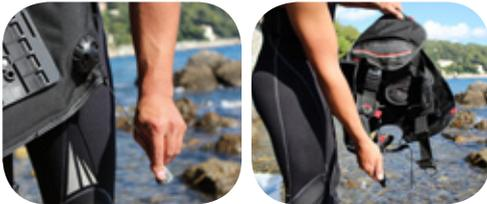
3. Svuota il jacket tramite il boccaglio e la valvola di scarico.
